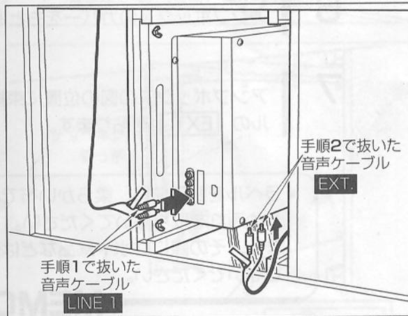
**11** チョウネジでアンプボックスの木製ボードを固定してください。
