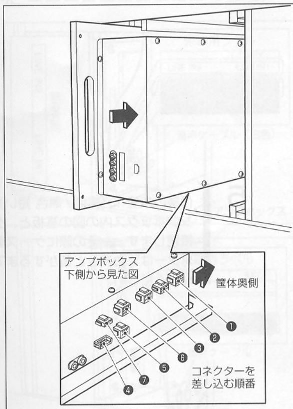
**10** アンプボックスを奥まで押し込み、先に抜いた音声ケーブルを接続します。
