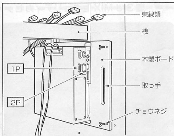
**8** チョウネジでPCBユニットの木製ボードを固定します。
