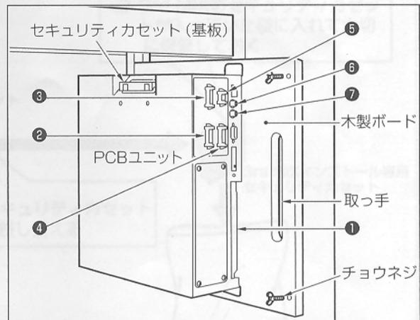
5 チョウネジを外し、PCBユニットを木製ボードごと、取っ手を持って取り出します。
