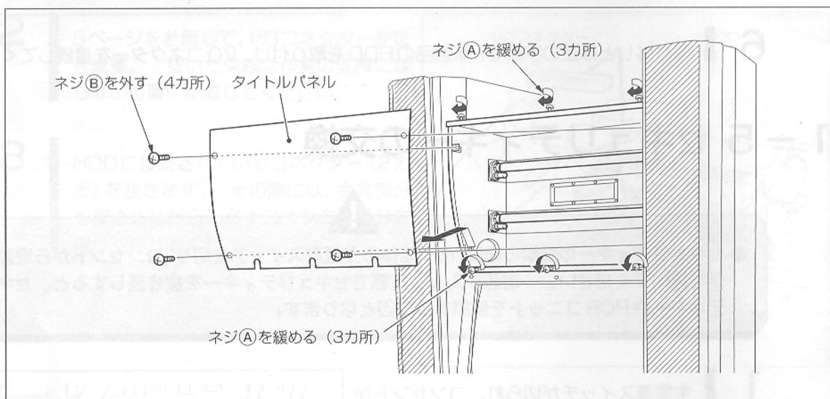
3 | 図のネジⒷを外し、上側をたわませるようにして、今までご使用のタイトルパネルを取り外します。
