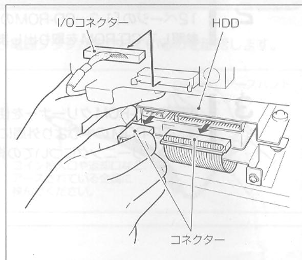
3 | HDDに接続されているコネクター(2カ所)を抜きます。その際には、金具部分を押さえながら、必ずコネクター部分を持って行ってください。
