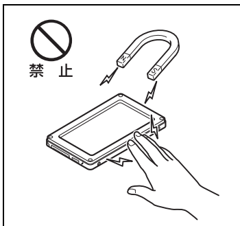
静電気を帯びた手や物で触らない 磁化したものを近づけない →故障の原因となります。
